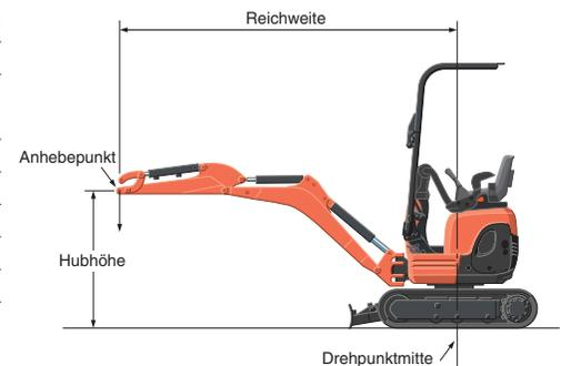
\* Die technischen Daten über den Arbeitsbereich der Maschine wurden mit dem Kubota Standard - Tieflöffel ermittelt, ohne Schnellwechseleinrichtung.
