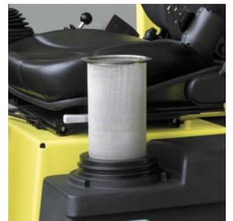
Wasser-Mehrfachfilterung und einfach zugängliche Berieselungsdüsen
