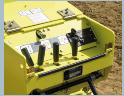
Modernes, übersichtliches Cockpit mit Funktionsüberwachung und Fehlerdiagnosesystem
