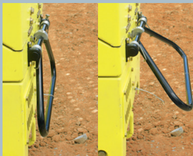
Arretierbarer Sicherheitsbügel zur Sicherheit des Bedieners
