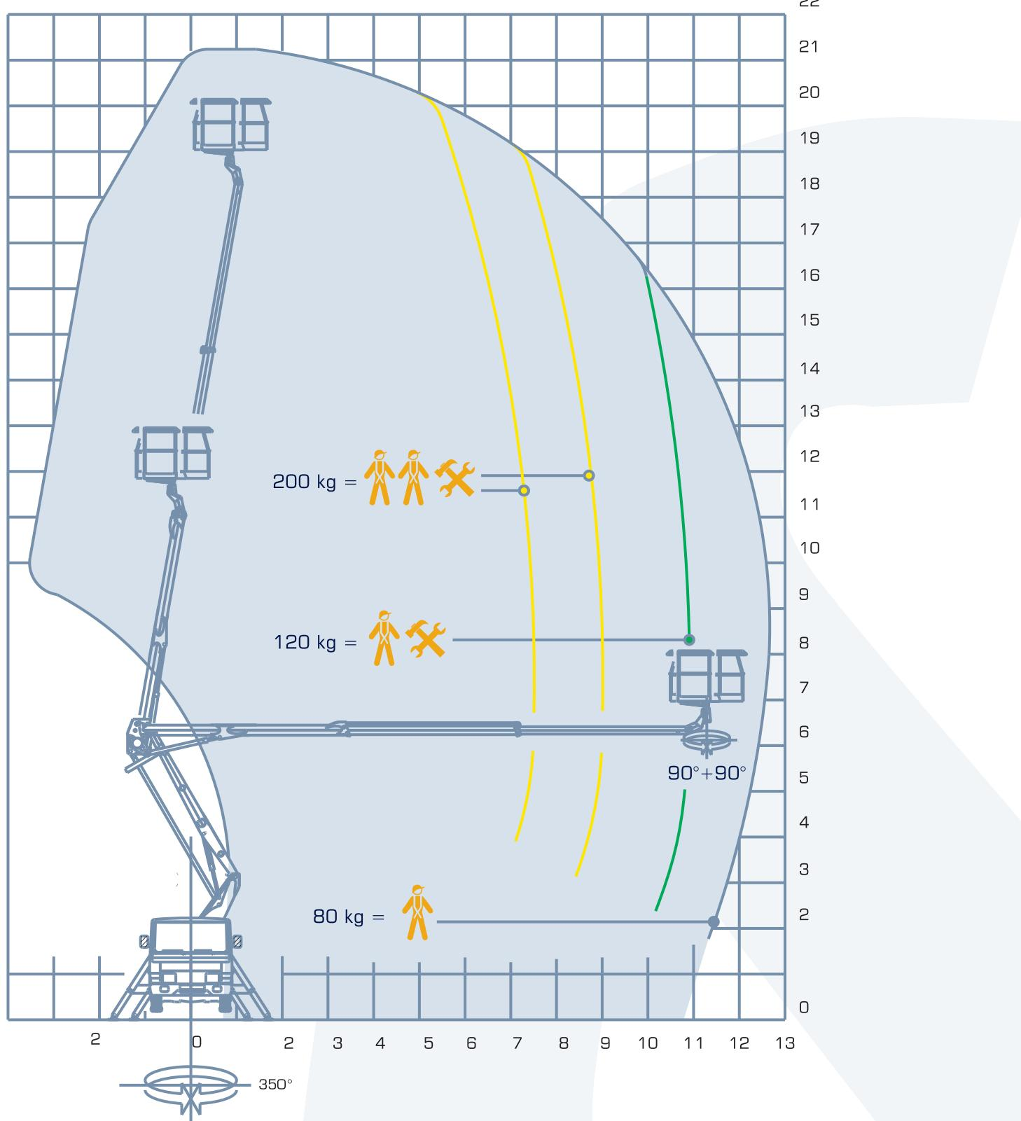
La Snake 2112 SMART è capace di un'altezza massima di lavoro di ben 21 m e di uno sbraccio laterale pari a 12 m.
